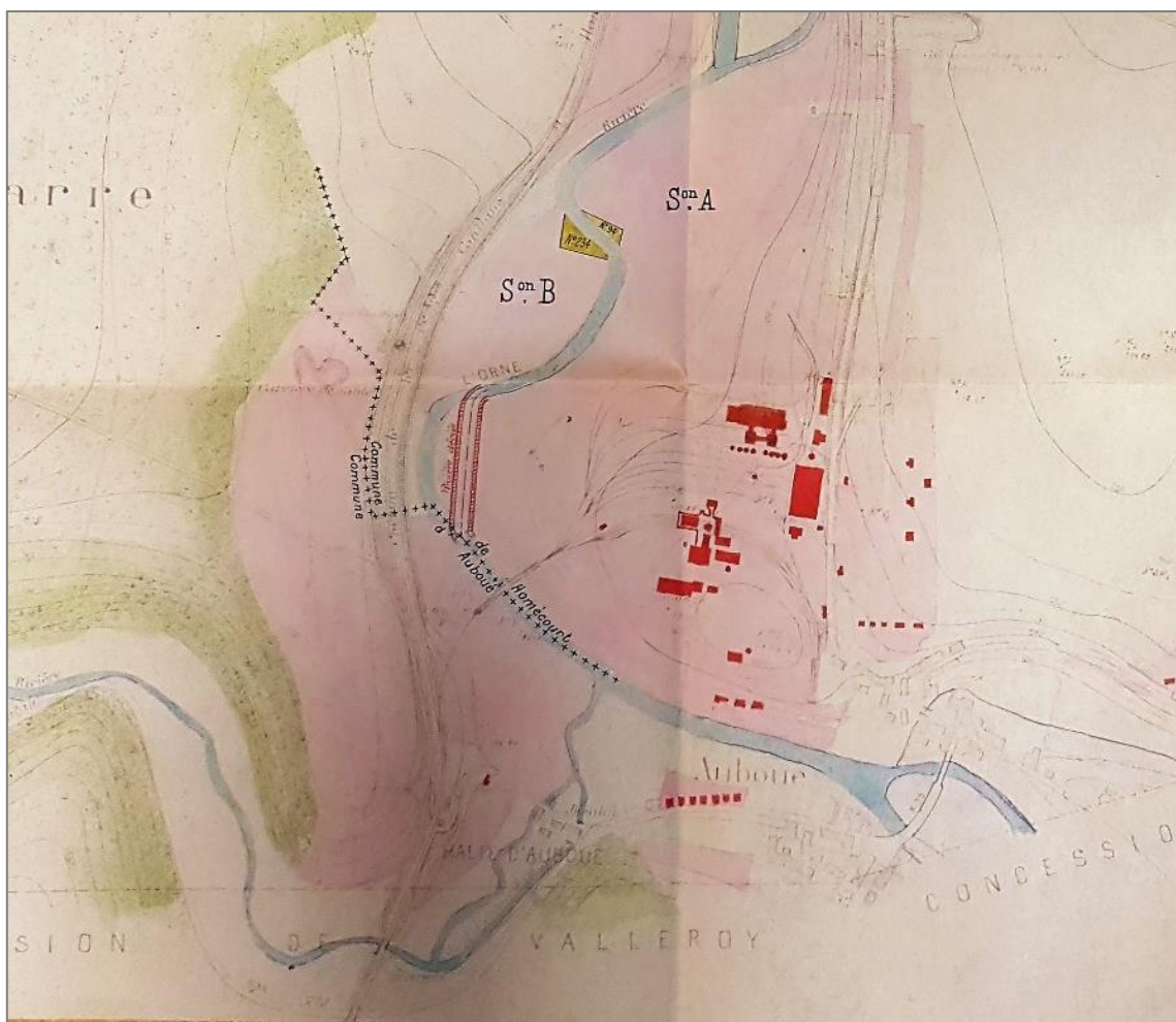
Figure 109 - Plan de dérivation de l'Orne 2. Ce plan de la dérivation de l'Orne est demandé par la société anonyme des hauts-fourneaux et fonderies de Pont-à-Mousson – 10 août 1907. La dérivation projetée figure en rouge sur le plan. (Source : AD54 - 3S88)
