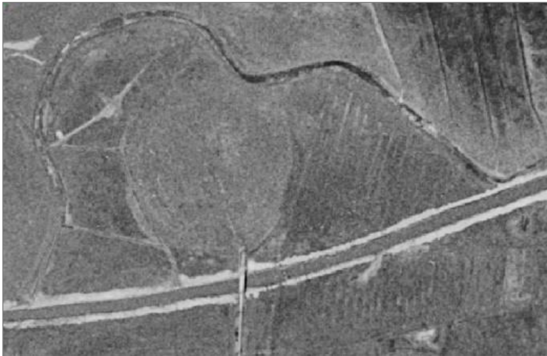
Figure 32 - Bourrelés de curage (en blanc) le long de la Seille rectifiée en aval de Moyenvic, 1950 ; (Source : Cliché 57-1955-0960-6860, IGN)
