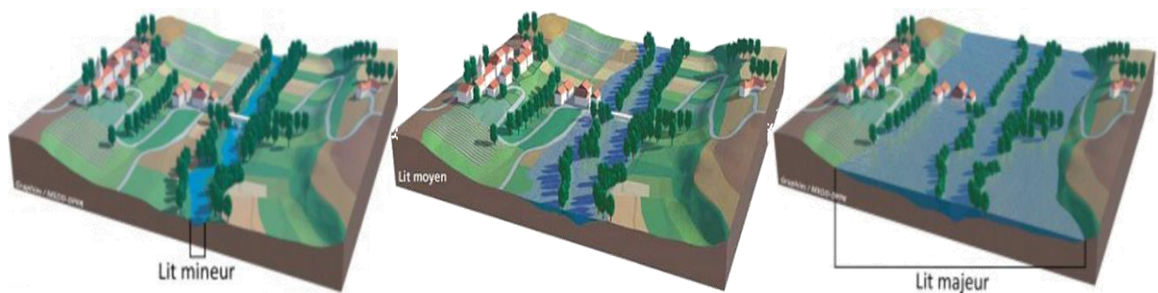
Figure 2 : Simulation d'un débordement de cours d'eau (Les différents lits d'une rivière © MEDD - Dossier informations inondations (août 2004))
