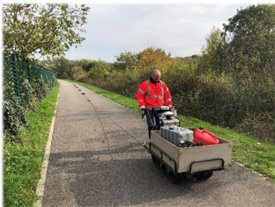
Investigations géophysiques sur la digue du Port de Metz par le BRGM (Syndicat Mixte Moselle Aval©)
