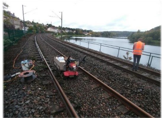
Investigations géophysiques sur la voie ferrée de Sierck-les-Bains par le BRGM (BRGM©)
